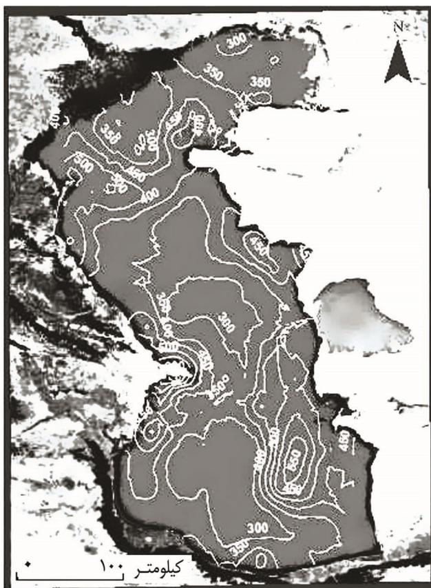
شکل ۸: تغییرات ضخامت محدوده تشکیل گازهای هیدراته در دریای خزر برای افزایش ۲ درجه‌ای دمای آب.
