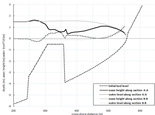
شکل ۴- نیمرخ ارتفاع موج، تراز سطح آب و عمق بستر در مقطع A-A و B-B در مدل SNCL1-250
