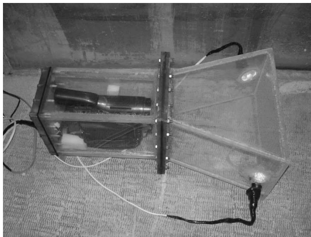
شکل ۴- نمایی از جعبه حاوی دوربین فیلمبرداری به منظور ضد آب نمودن آن
