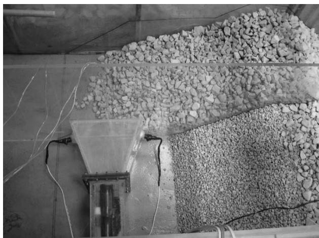
شکل ۵- نمایی از تقسیم‌بندی فلوم و چگونگی اجرای سازه موج‌شکن سکویی
