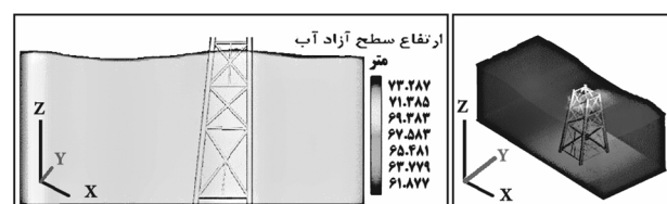
شکل ۹: شبیه‌سازی برخورد امواج به همراه تغییرات سطح آزاد سکوی دریایی در خلیج فارس
